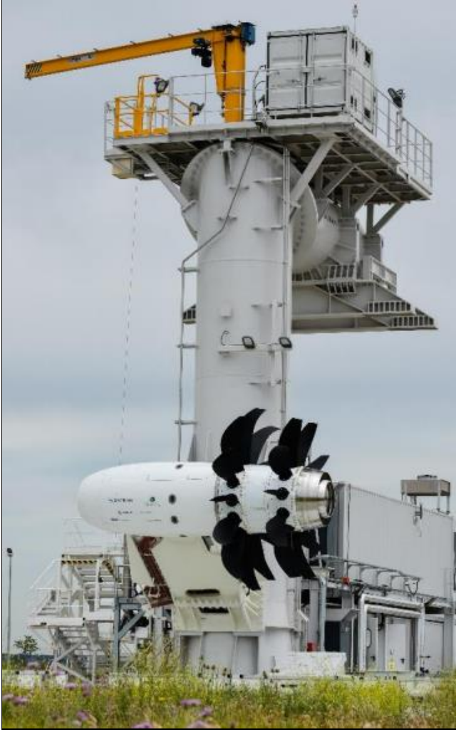
Şekil 5: Temiz Gökyüzü Projesi Açık Rotor Motor Testi Kaynak: CleanSky, 2019.
