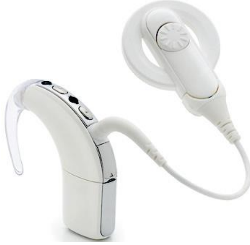
Şekil 7. Koklear implantın dış parçaları
