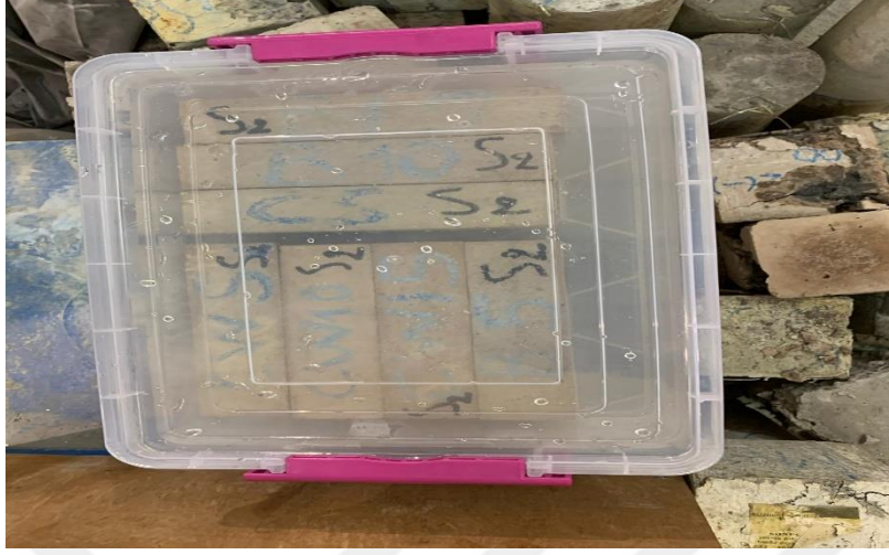
Şekil 2.9 Numunelerin sülfat çözeltisine maruz bırakılması
