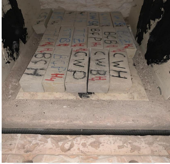
Şekil 2.10 Yüksek sıcaklık testi sonrası numuneler
