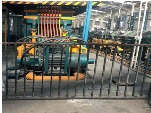
Resim 9. Ekstrüzyon makinasının arka kısmı kapatılarak operasyon bölgesine erişimin engellenmesi olumlu örnekler
