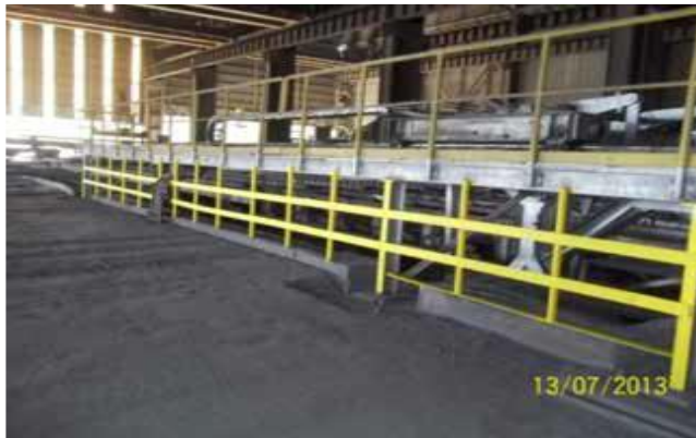
Resim 15. Açıkta kalan platformun altına düşmemesi için korkulukla kapatılması olumlu örnekler
