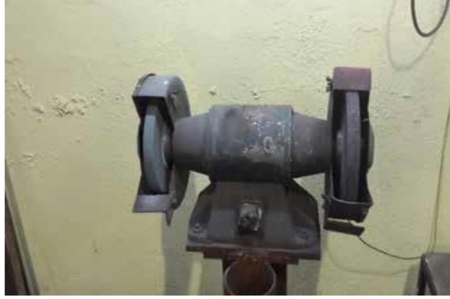
Resim 7. Taş motoru koruyucuları olumlu örnekler
