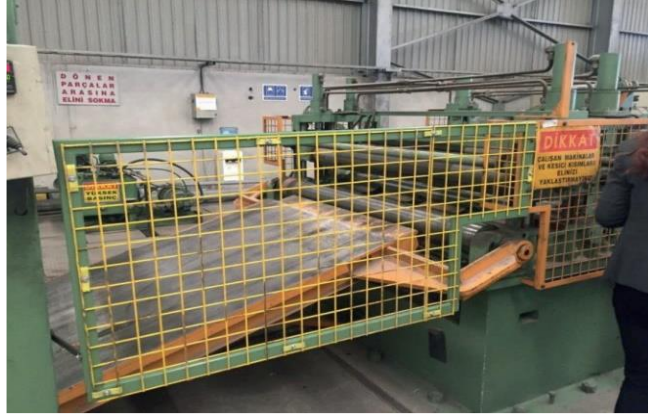
Resim 4. Profil makinası sac besleme koruyucusu olumlu örnekler
