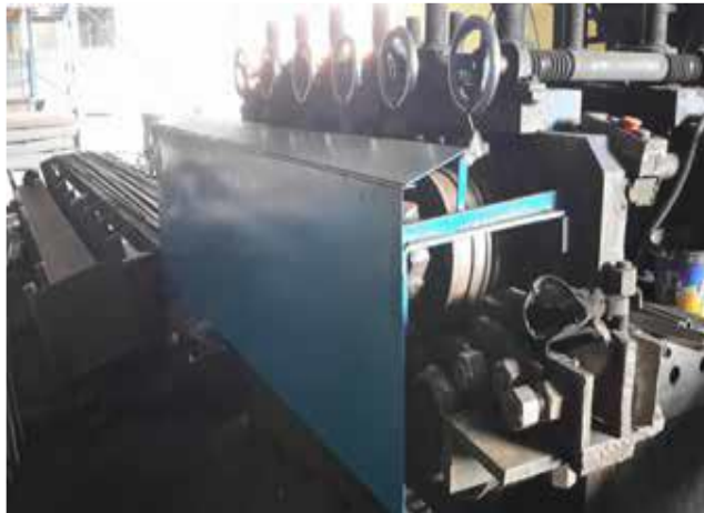
Resim 12. Doğrultma makinalarının koruyucu içine alınması olumlu örnekler
