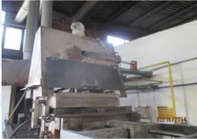
Resim 14. Kalay döküm fırınının açıkta olan yan kapaklarının kapatılması olumlu örnekler
