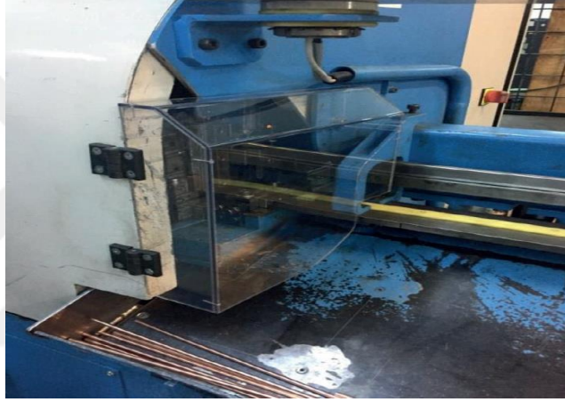
Resim 5. Kesme makinasında kesme bıçağının kapatılması olumlu örnekler
